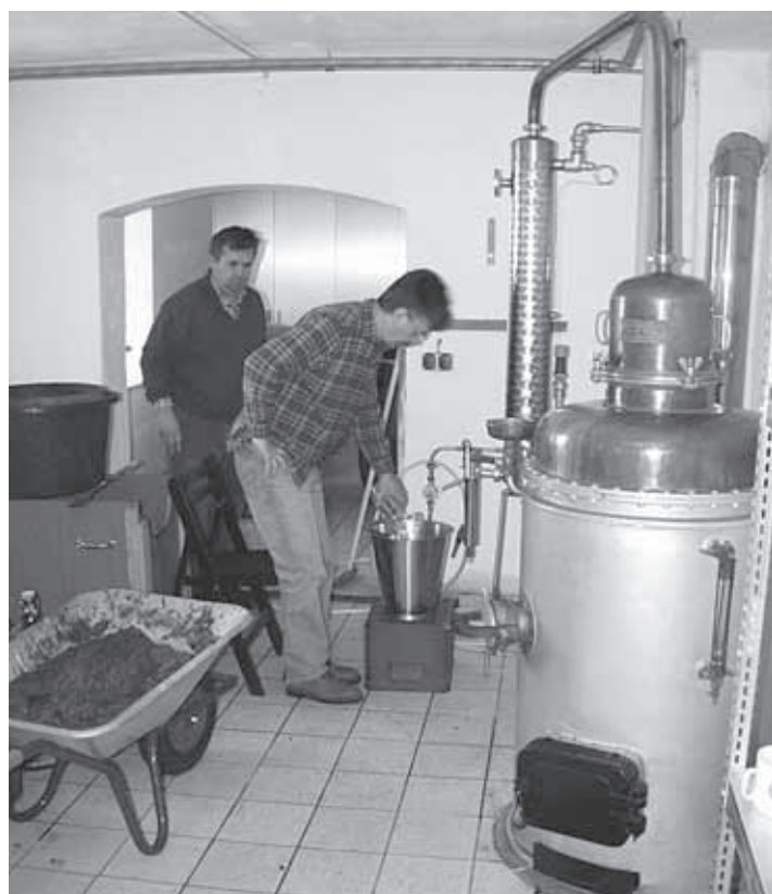
Das Herzstück in der Brennerei: Der Heizkessel, der den Alkohol aus der Maische entweichen lässt. Mit sorgsamem Blick auf das Ergebnis Werner und Fritz Betzl (v.l.)
