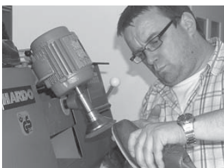
Feinausputz (Schleifvorgang) an der kombinierten Schuhmachermaschine
